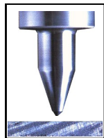
VHM-Bohrer ansetzen und ins Material drücken.
